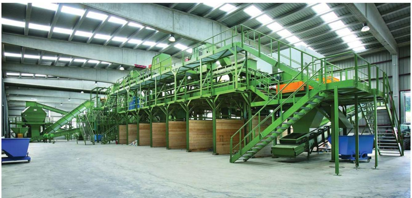
clasificación, equipo de doble cuerpo con dos luces de cribado, una de 80 mm y otra de 150 x 300 mm.
