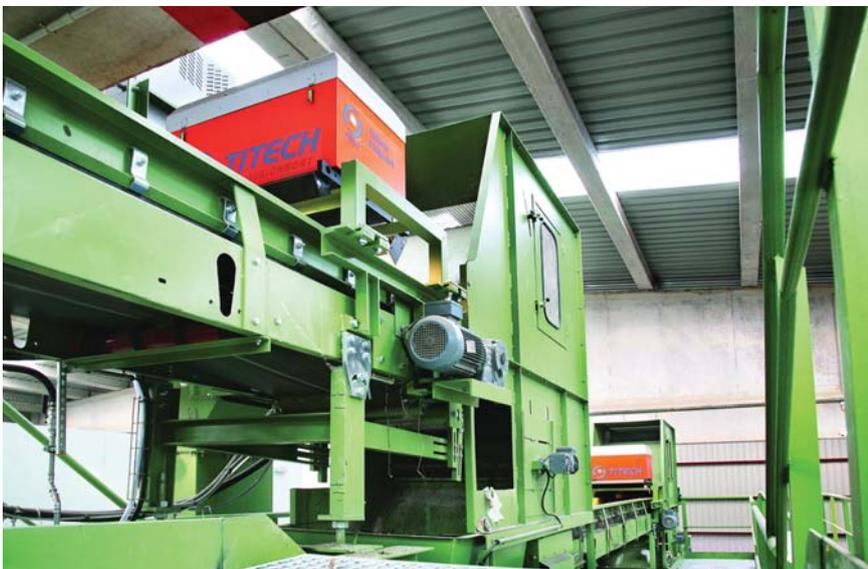
y que pasará por los separadores ópticos. En ese punto de conexión, se realiza una captación neumática de la parte de film y ligeros que puedan quedar.
