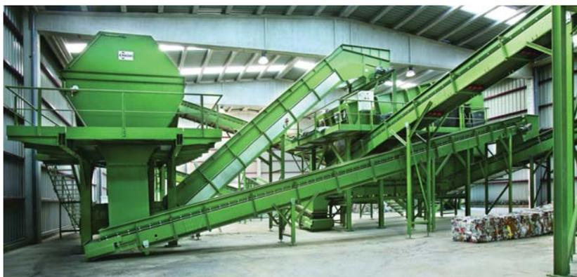
dos”) y el de la fracción rechazo del trómel > 150 x 300 mm se unen en una cinta de elevación que los conduce a una segunda cabina de triaje. Antes de llegar a la clasificación manual, estos residuos son sometidos a una separación magnética mediante un separador electromagnético Felemang.
