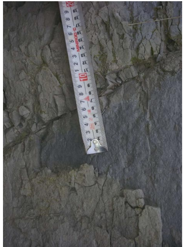
F22. Detall diaclàsi en calcarenites de la unitat B
